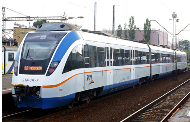
Zestaw Kolejowy EZT typu 14WE będący zmodernizowaną wersją EN57 przy obsłudze pociągu SKM Warszawa na stacji Warszawa Wschodnia,
