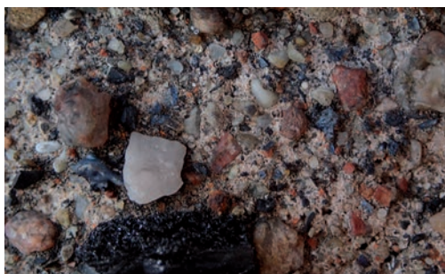
Makroskopowy wygląd zaprawy z gruboziarnistym wypełniaczem, m.in. z dodatkiem węgla i zendry kowalskiej
